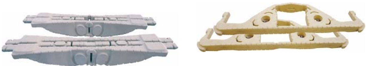
Kerne für Waggonguss Rahmen und Balken der Chinesischen Eisenbahn, Kernlänge ca. 2500 / 2300 mm
